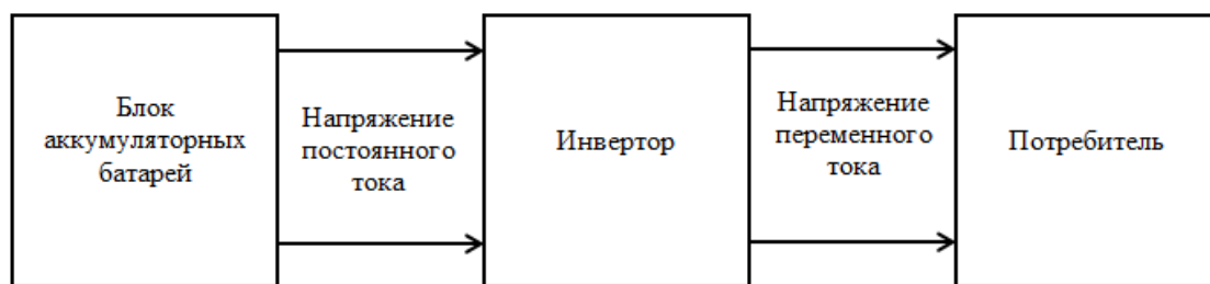
Рис. 2.2. Схема преобразования энергии от блока аккумуляторных батарей до потребителя
