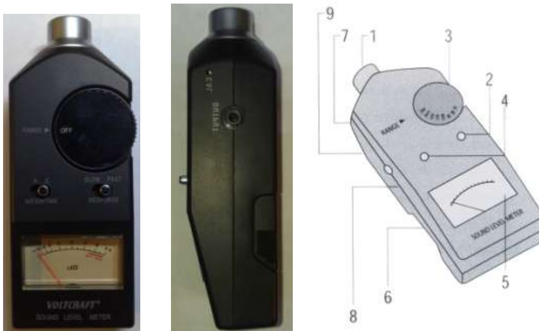
Рис. 1. Прибор VOLTcraft для измерения шума: 1 – капсула микрофона; 2 – переключатель демпфера (глушителя) звуковых колебаний; 3 – колесо регулирования и вкл/выкл прибора; 4 – выбор фильтра; 5 – аналоговый дисплей; 6 – отсек батареи; 7 – калибровочный потенциометр; 8 – адаптер для треноги; 9 – гнездо выхода.
